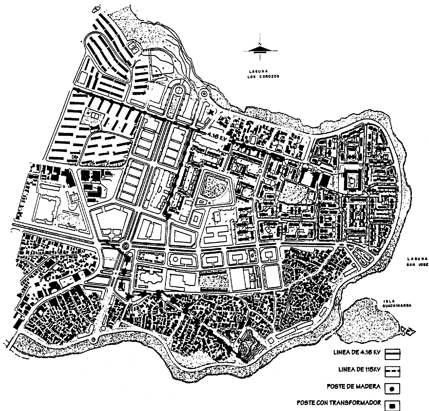
Ilustración III-14 - Sistema de Energía Eléctrica Existente
